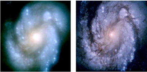
Images du télescope Hubble : avant et après correction des aberrations
